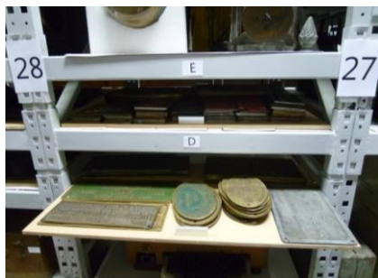
Przesuwane płyty ze sklejk w regałach z półkami to prosty i tani sposób na przechowywanie obiektów w pozycji leżącej © ICCROM
