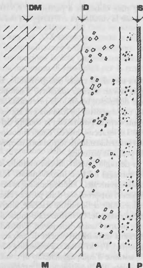
Fig. 44 - Schema di taglio, indicando il livello di separazione in vista della rimozione di una pittura murale. M = muro; A = arriccio; I = intonaco; P = strato pittorico; S = strappo; D = stacco con intonaco; DM = stacco a massello con parte del supporto.
