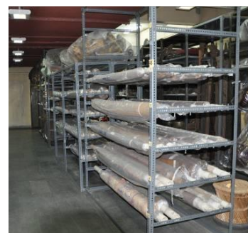
Estantes modificadas com barras horizontais para sustentar os cilindros © ICCROM
