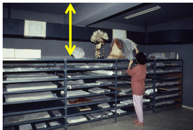
A altura útil, ou espaço vertical utilizável, nem sempre é igual à altura da sala devido a várias obstruções (neste caso, dutos de ventilação) © ICCROM
